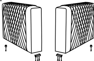
3. Установив сиденье дивана на спинку, вкрутить 7 пластиковых опор с использованием саморезов 4х45 как показано на рисунке
