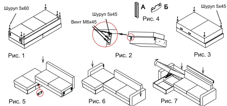
← перевернуть секцию с подъёмным элементом, уложив мягким элементом вниз на предварительно подстеленный картон. Прикрутить опоры при помощи шурупов согласно рисунку 3. Поставить секцию с подъёмным элементом на опоры.
