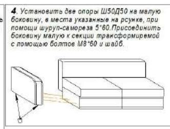
4. Установить две опоры W50D50 на малую боковину, в места указанные на рисунке, при помощи шурупа-самореза 5\*60. Присоединить боковину малую к секции трансформируемой с помощью болтов M8\*60 и шайб.
