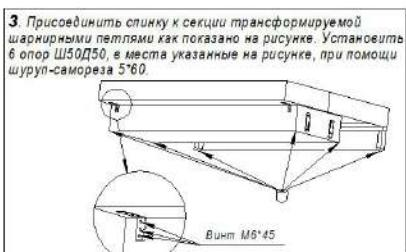
3. Присоединить спинку к секции трансформируемой шарнирными петлями как показано на рисунке. Установить 6 опор W50D50 в места указанные на рисунке, при помощи шурупа-самореза 5\*60. Присоединить боковину малую к секции трансформируемой с помощью болтов M8\*60 и шайб.
