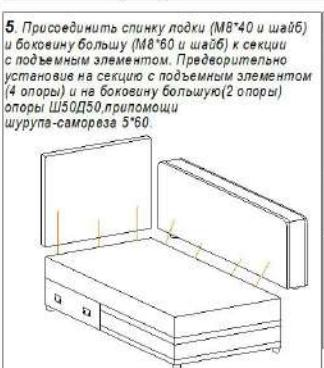
5. Присоединить спинку лодки (M8\*40 и шайб) и боковину большую (M8\*60 и шайб) к секции с подъемным элементом. Предварительно установить на секцию с подъемным элементом (4 опоры) и на боковину большую (2 опоры) опоры W50D50, при помощи шурупа-самореза 5\*60.
