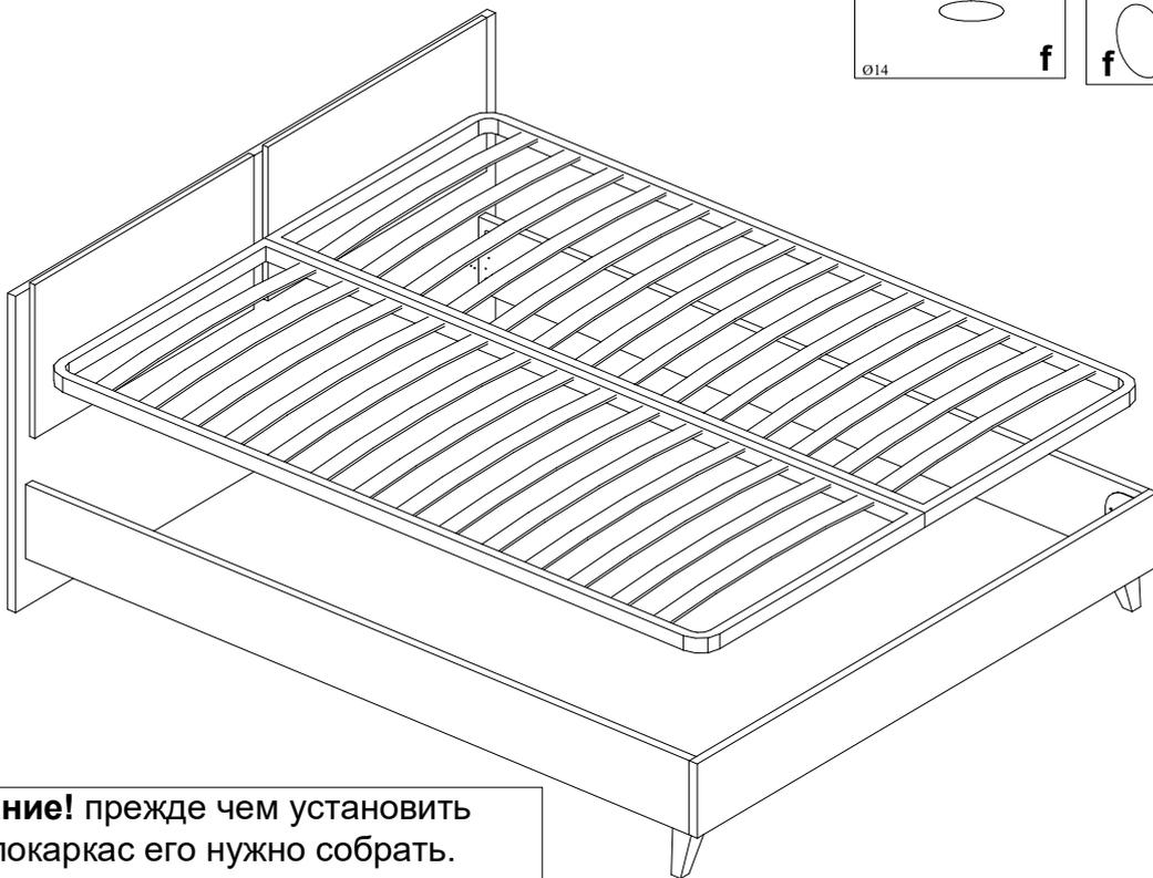
**Внимание!** прежде чем установить металлокаркас его нужно собрать. Возле изножья две ноги от металлокаркаса **не прикручиваются**
